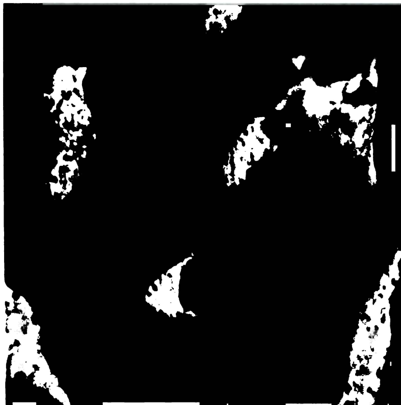
FIGURA 1. Imatge química d'un aliatge de Cu-Ag-S vista amb un microscopi electrònic.
